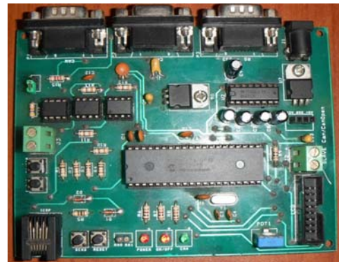
Figura 1. Tarjeta de comunicación elaborada para la aplicación.
