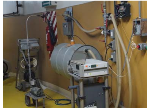
Figura 1. Cadena de medición y el MAB 1000.
