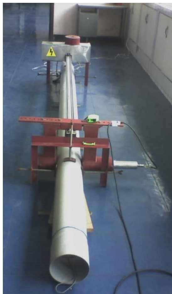
Figura 3. Columna evaluada con perfilaje gamma.
