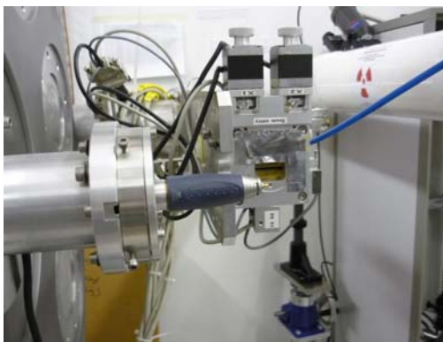
Figura 3. Vista del capilar portamuestra, frente a la rendija del detector, en el goniómetro de la línea BM25 – SpLine.
