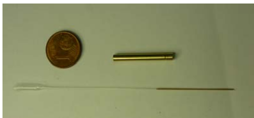
Figura 2. Capilar portamuestra de vidrio, con el cartucho de bronce que se coloca en el rotor para realizar la medida.
