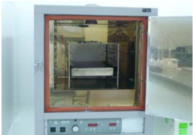
Figura 4. Disposición de la bandeja dentro de la caja de acero inoxidable para su esterilización.
