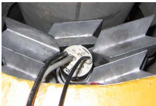
Figura 3a. Ubicación del detector de NaI (Tl) y el colimador de prueba (espesor de pared 2 cm).
