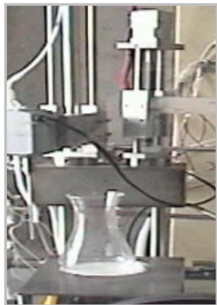
Figura 3. Sistema de extracción de la FO.
