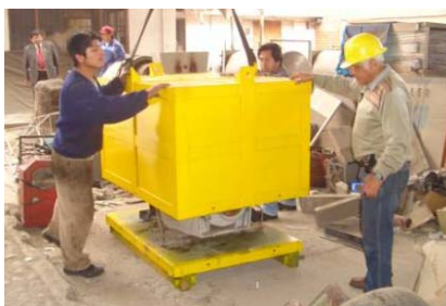
Figura 6. Acondicionamiento para transporte del cabezal.
