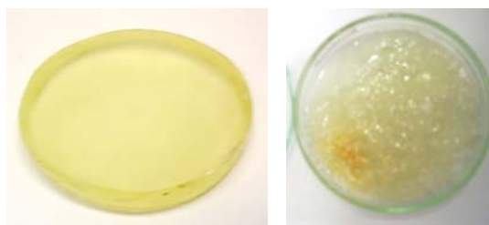
Figura 2. Polimerización de una mezcla poliéster-estireno 1:1 por radiación gamma (izquierda) y por microondas (derecha).
