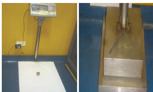
Figura 7. Martillo de impacto para el punzado e impacto sobre la cápsula.
