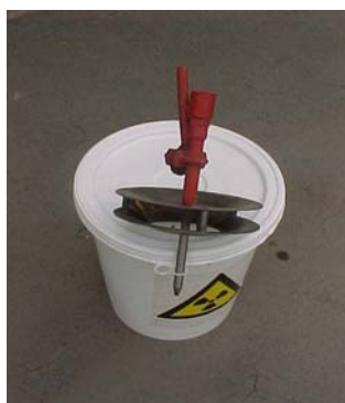
Figura 2. Pararrayo y contenedor de PVC.
