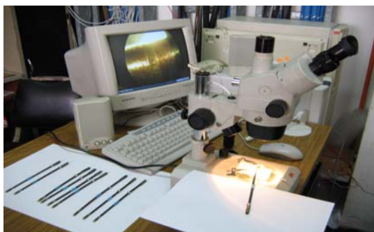
Figura 3. Inspección visual con estereoscopio y toma de imágenes de los porta fuentes.
