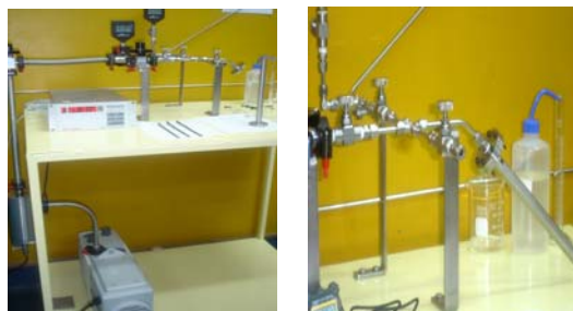
Figura 5. Sistema mecánico para alto vacío (Ramal 2).
