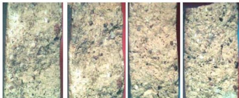
Figura 2. Fractografías, obtenidas a la misma amplificación con microscopio de luz, de fracturas diversas correspondientes a 5 fragmentos de cerámicas Nasca de las fases V-VIII.
