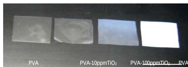
Figura 4. Películas obtenidas con la mezcla PVA- \text{TiO}_2 .
