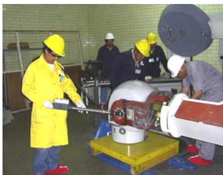
Figura 2. Verificación de niveles de tasa de dosis.
