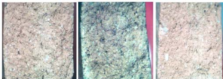
Figura 1. Fractografías, obtenidas a la misma amplificación con microscopio de luz, de fracturas diversas correspondientes a 5 fragmentos de cerámicas Nasca de las fases II-IV.
