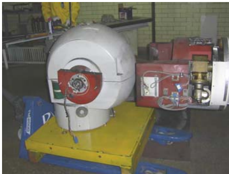
Figura 5. Cabezal liberado del brazo del Gantry.
