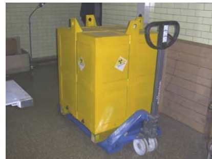
Figura 8. Retiro del cabezal colocado en un contenedor para su transporte.
