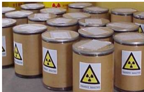
Figura 3. Pararrayos con sus contenedores de transporte procedentes de Yanacocha.
