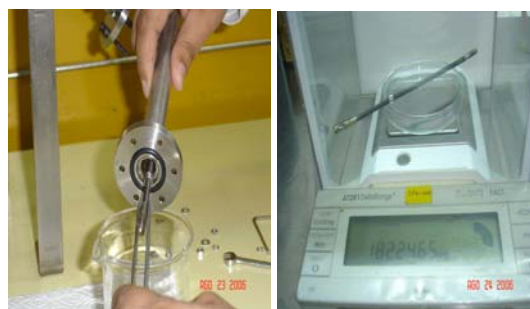
Figura 9. Manipulación y pesado del porta fuente después del ensayo.
