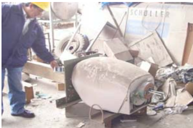
Figura 3. Medición de tasa de dosis de cabezal de teleterapia.
