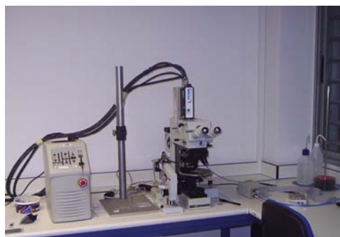
Figura 2. Sistema Micro-LIBS utilizado en el análisis de muestras cerámicas.
