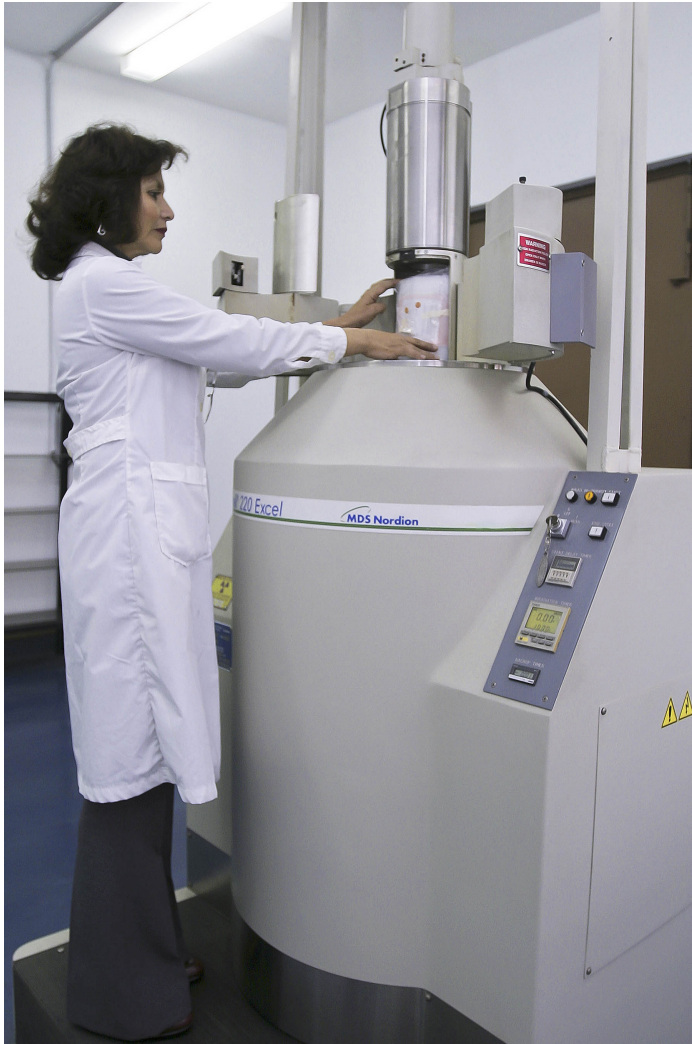
Figura 10.5: El irradiador gamma del Instituto Peruano de Energía Nuclear es usado para calcular las dosis apropiadas para generar mutaciones que mejoren las plantas y para esterilizar productos médicos. Foto IPEN.
