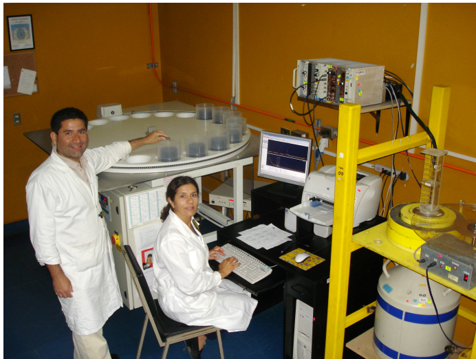
Figura 10.1: Sala de espectrometría \gamma , donde es analizada la radiación emitida por muestras irradiadas en el reactor RP-10, para fines de análisis químico. Foto IPEN.
